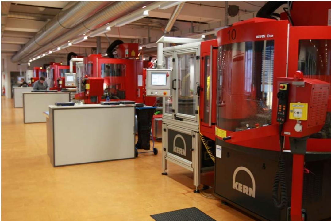
IMG_6784 Teilefertigung auf KERN Evo mit ER6
